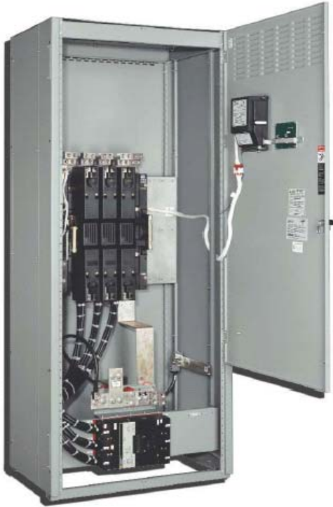
FIG.15 – Cubículo de transferência ASCO de serviço de entrada – dados nominais: 800 A, 3 pólos, grau de proteção NEMA 1
